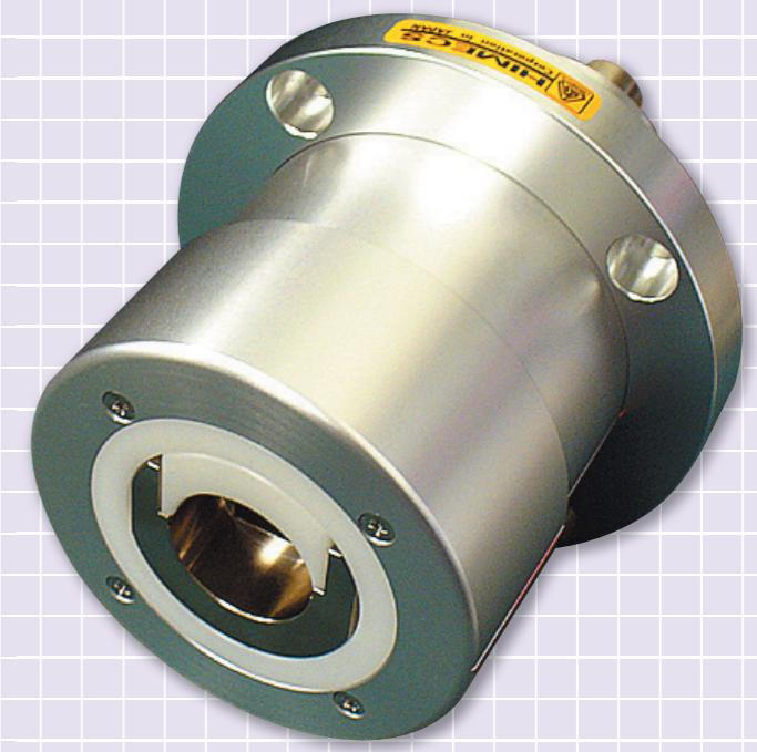
SELF LOCK은 권취축/플림 축을 지탱하며 권취축으로 구동 또는 제동이 걸리는 구조로 되어 있습니다. SELF LOCK 주축이 90도 회전하면 자동으로 뚜껑이 닫혀 권취 축이 떨어지지 않게 하는 구조. 즉 작업 실수 방지를 위한 권취축 지지 장치입니다. 권취축/플림 축 물리는 쪽의 시리즈화에 의해 설계 및 제조 비용 절감에 기여합니다.
