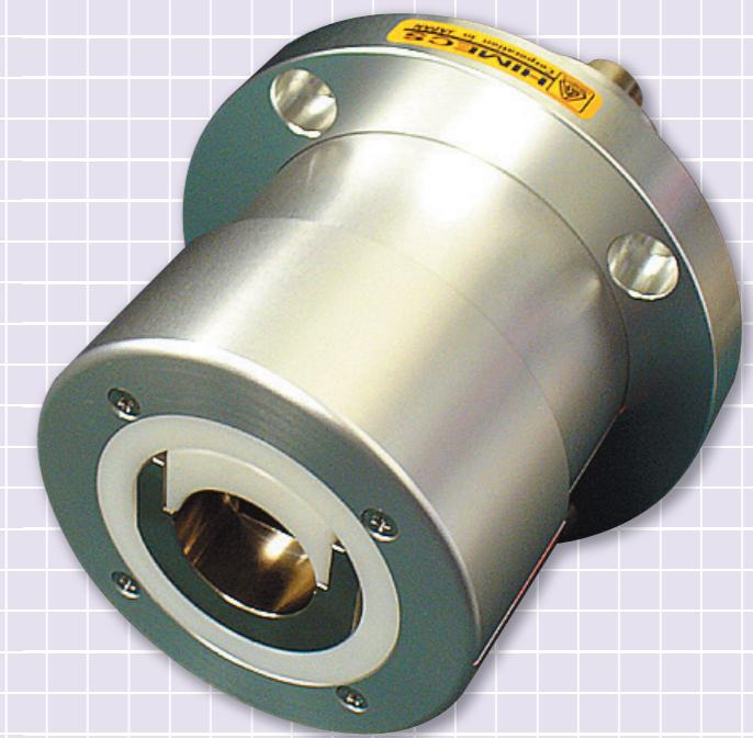
Self Lock可支撐收卷軸及出料軸,並控制收卷軸驅動及制動的構造。為了作業安全,當主軸迴轉成90度時,蓋子會自動關上,使收卷軸不會掉下,也可說是防止作業疏失的一種收卷軸支撐裝置。
